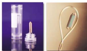
Sample Mount Pin & Cryoloop
